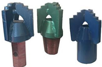
Gli scalpelli a lame trovano ampio utilizzo in fori per jet grouting, pozzi per acqua e ricerche minerali. Danno ottimi risultati nella perforazione di formazioni poco consolidate (argille-sabbie-marne etc.). Disponibili nel tipo «Step» (a gradini) o tipo «Chevron» (lame dritte).
